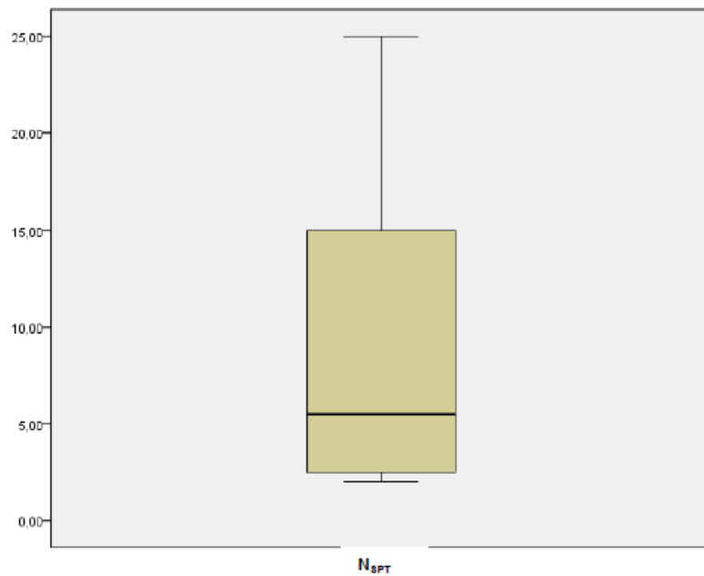
Figura 4.15 - Gráfico do tipo Box plot para valores de N_{SPT} – Solos porosos lateríticos superficiais.
