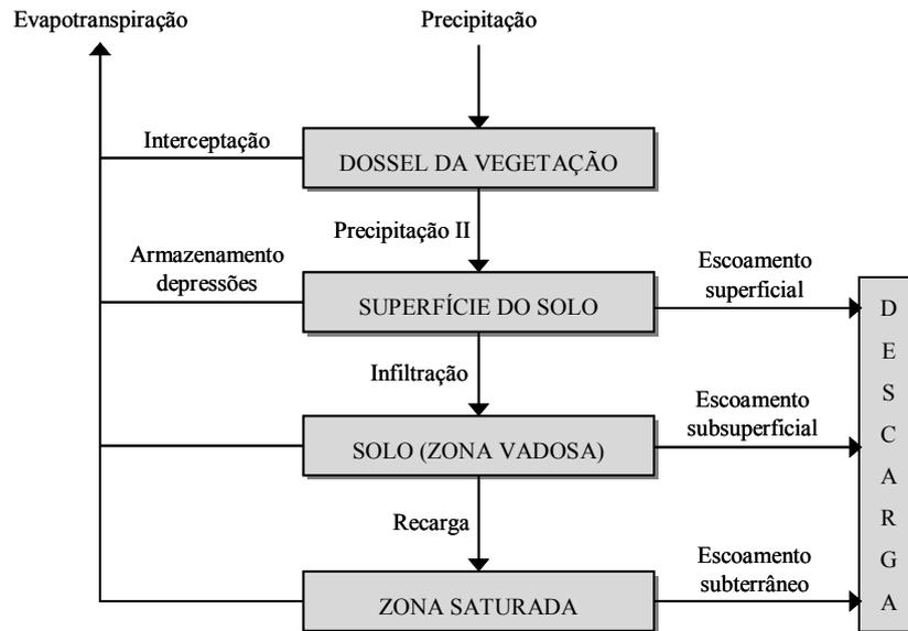
Figura 4.14 – Processos hidrológicos e estrutura do modelo WETSPA
