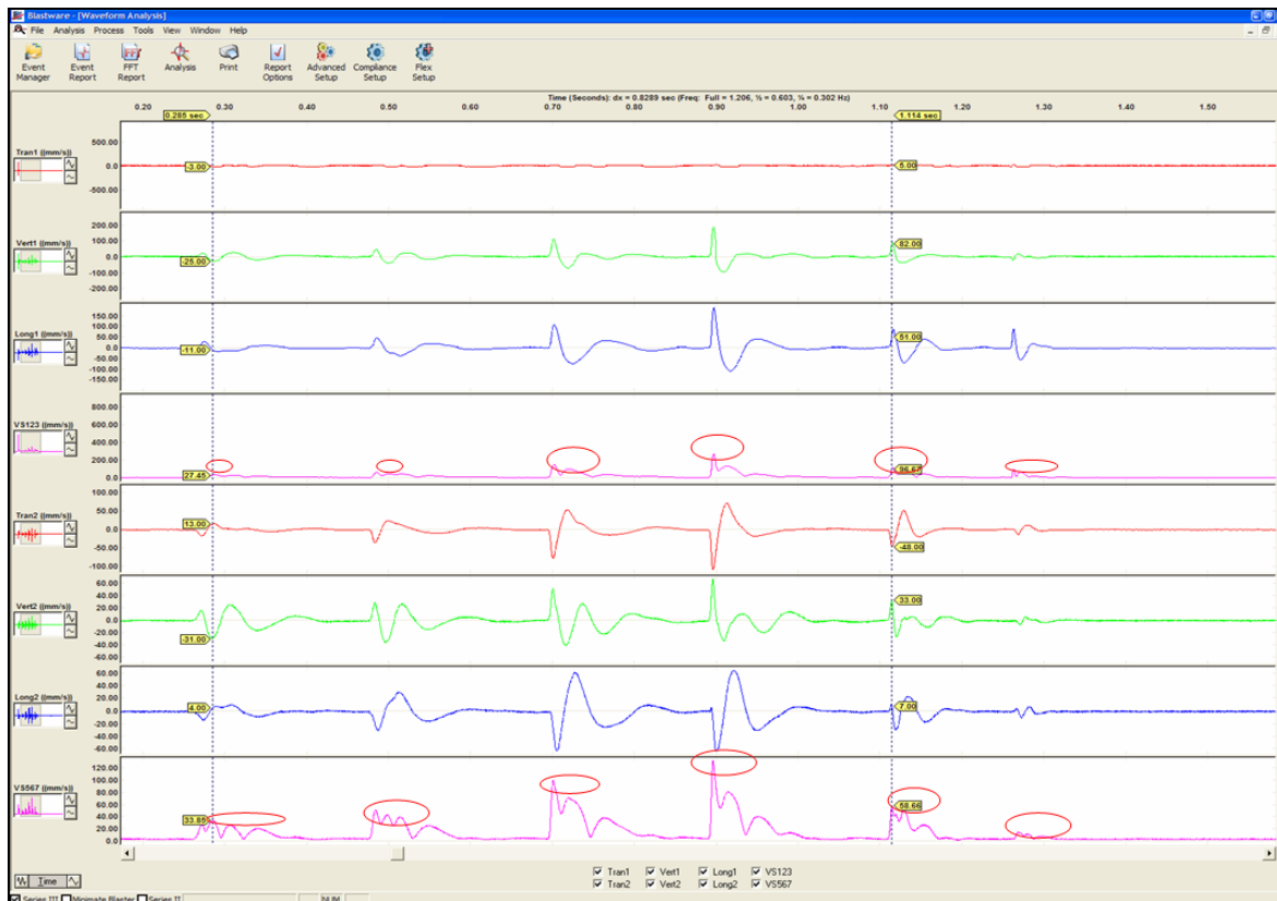
Figura 5.21 – Ondas P e valores do PPV úteis para o modelo de vibrações no campo próximo.
