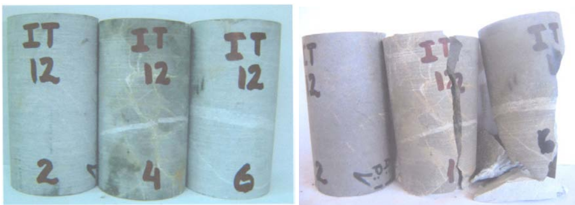
Figura 5.12 – Corpos de prova levado à ruptura no ensaio de triaxial para o caso do ensaio 12 no monzonito do talude Chabuca (antes e depois).
