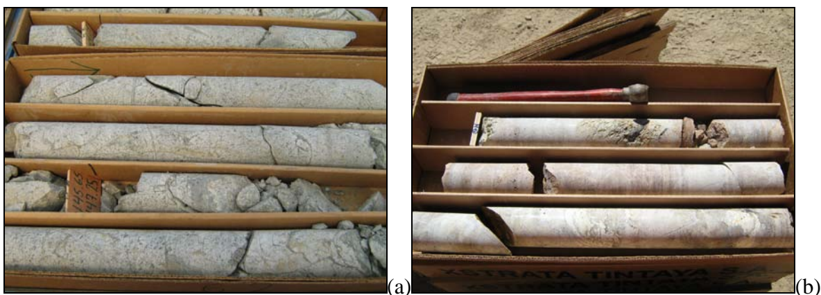
Figura 5.1 – Testemunhos HQ de sondagem geotécnica: a) monzonito; b) andesito.
