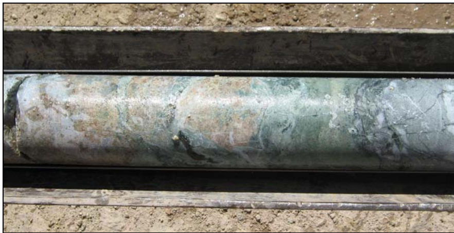
Figura 5.9 – Testemunho de sondagem HQ levado para ser ensaiado no laboratório.
