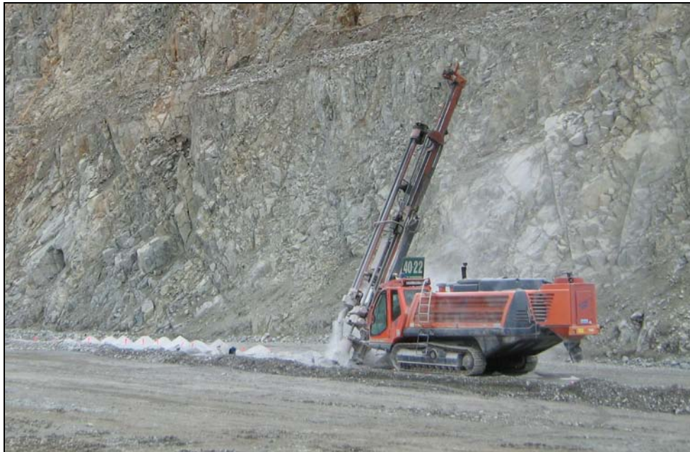
Figura 3.3 – Máquina perfuradora de pré-corte de 12,7 cm (5”) para colocação do geofone.
