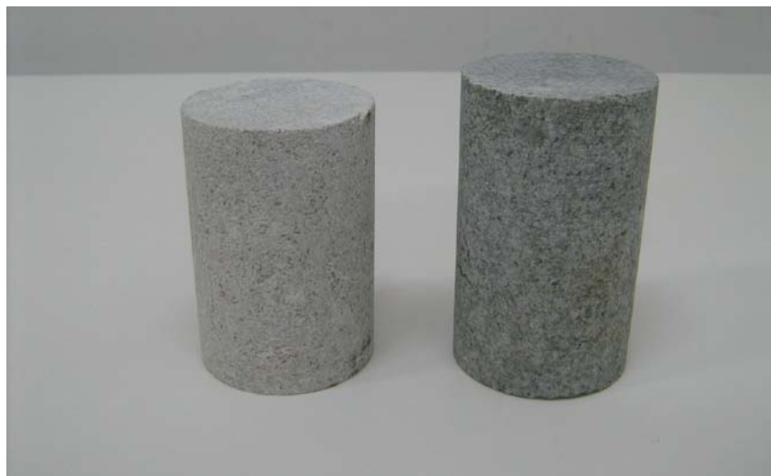
Figura 5.15 – Amostras de rocha intacta de quartzo monzonito (esquerda) e pórfiro monzonito (direita) para o ensaio de velocidade sônica de propagação de ondas P.
