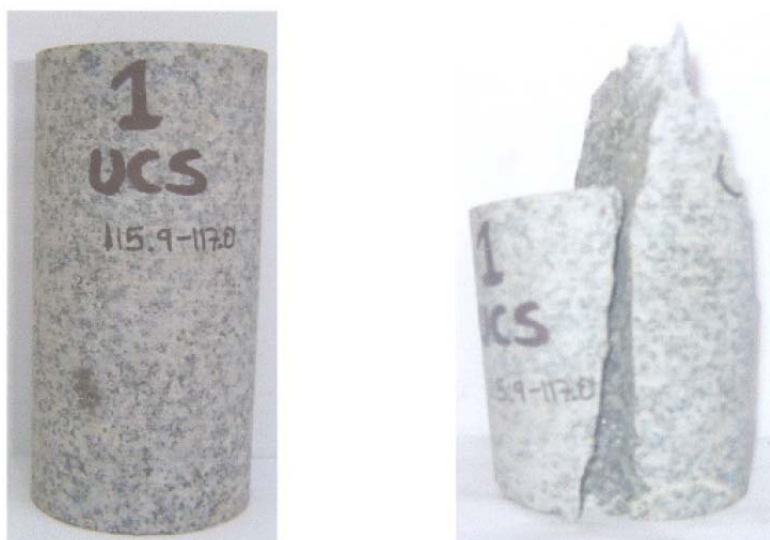
Figura 5.10 – Corpo de prova levado à ruptura no ensaio de resistência à compressão uniaxial para o caso do ensaio 1 no monzonito do talude Tintaya (antes e depois).
