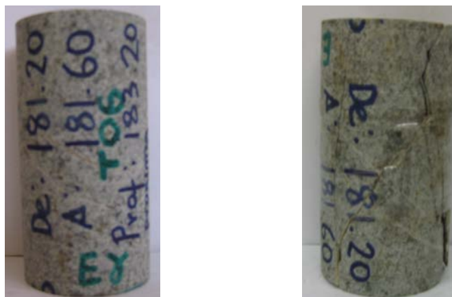
Figura 5.13 – Corpos de prova onde se obtiveram os módulos elásticos da rocha intacta do ensaio 6 no monzonito do talude Chabuca (antes e depois).
