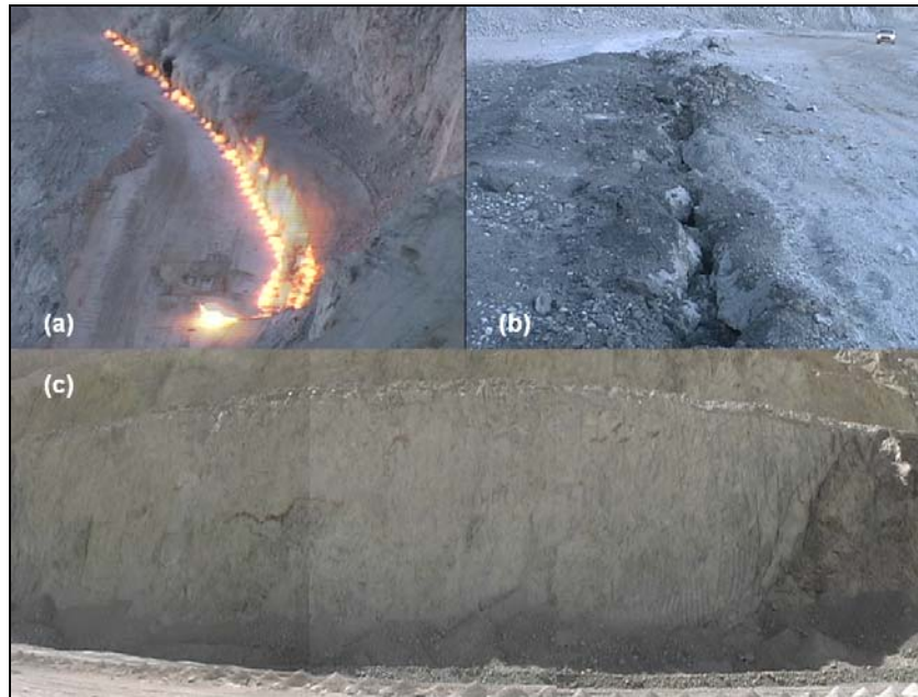
Figura 2.34 – Técnica do pré corte para evitar dano nas paredes (a) fim da detonação do pré corte com retardamento (b) resultado da perfuração do pré corte, observasse a trinca que atua como um plano imaginário para fuga dos gases da detonação da produção (c) parede rochosa sem irregularidades, sem blocos na crista e com a metade de canhas do pré corte.
