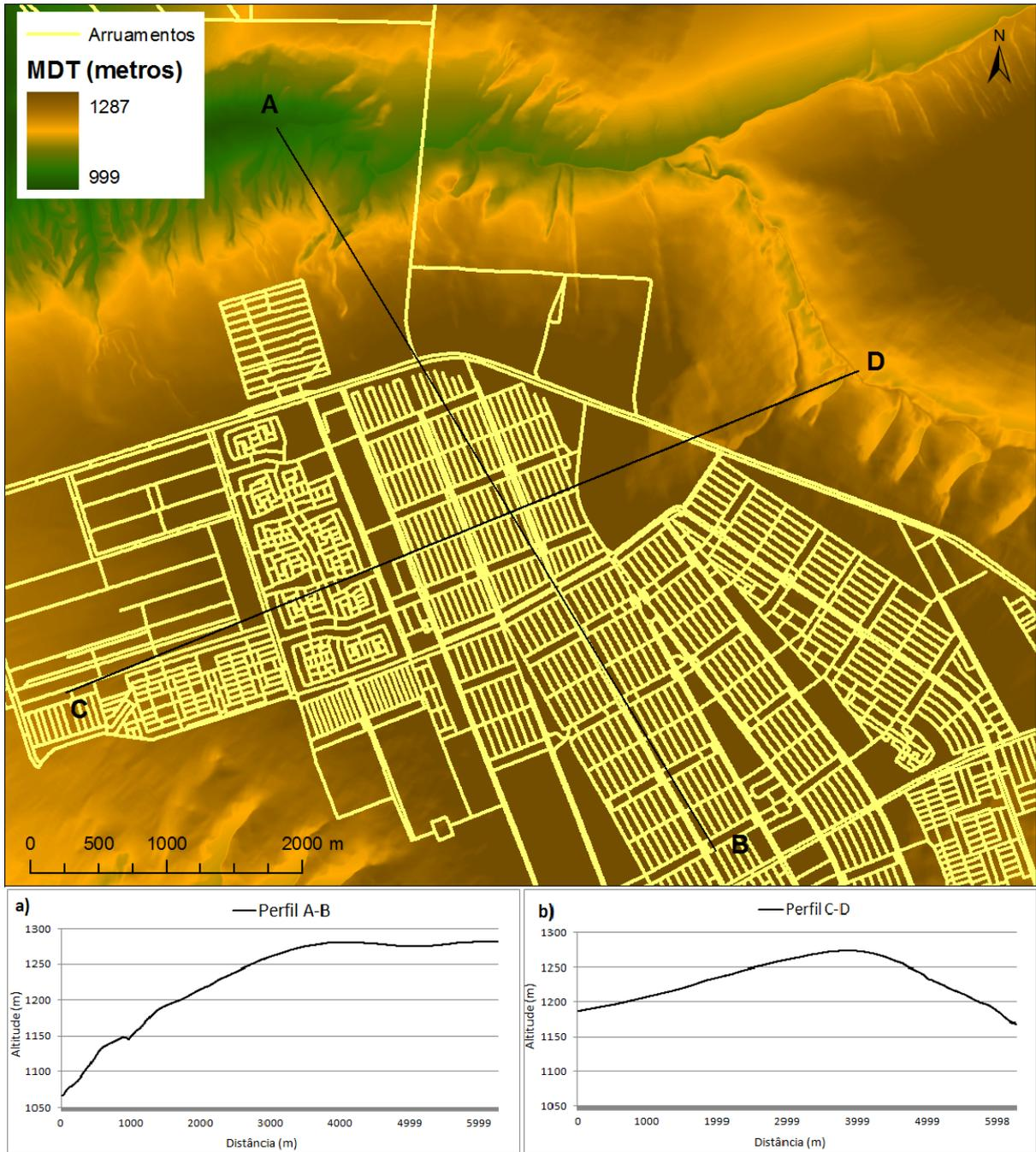
Figura 5.21 – Perfis topográficos da área da Ceilândia. Ambos mostram que não há ruptura de declive acentuada entre a chapada e o vale.
