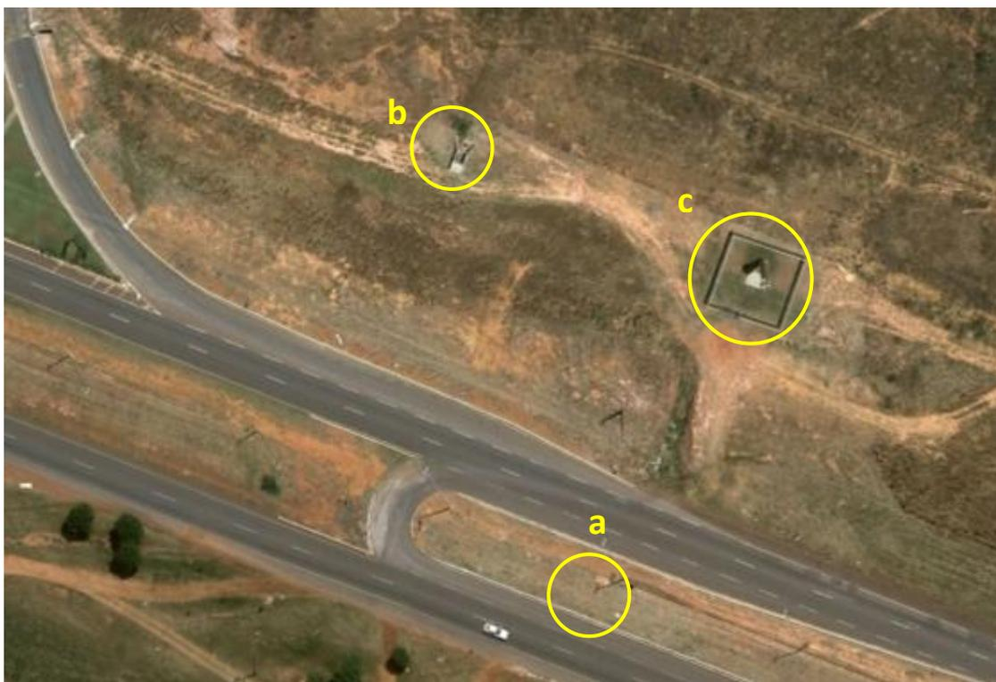
Figura 5.27 – Estruturas do sistema de drenagem de águas pluviais. No destaque (a) parte da estrutura de coleta das águas pluviais, (b) estrutura para descarga da água coletada e (c) estrutura da adutora da CAESB.
