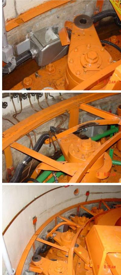
Figura 2.9: Distribuidor após falha de 20 pinos de cisalhamento.
